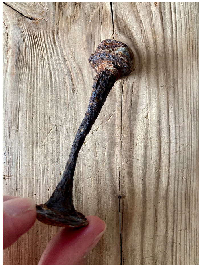
En gammel bolt fra projektet med at skifte en bundstok i forskibet af Chresten K.
